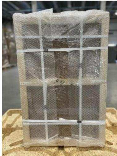
**2-й вариант:** пузырчатая плёнка или пенопласт + деревянная обрешётка без острых углов + пузырчатая плёнка поверх обрешётки.
